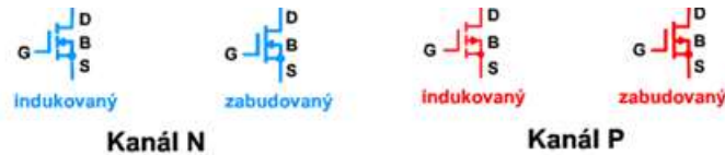
Obr. 28 Schematická značka MOSFET
